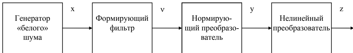
Рисунок 3.20. Генерирование ПСП с заданным видом корреляционной функции и законом распределения отличным от нормального
