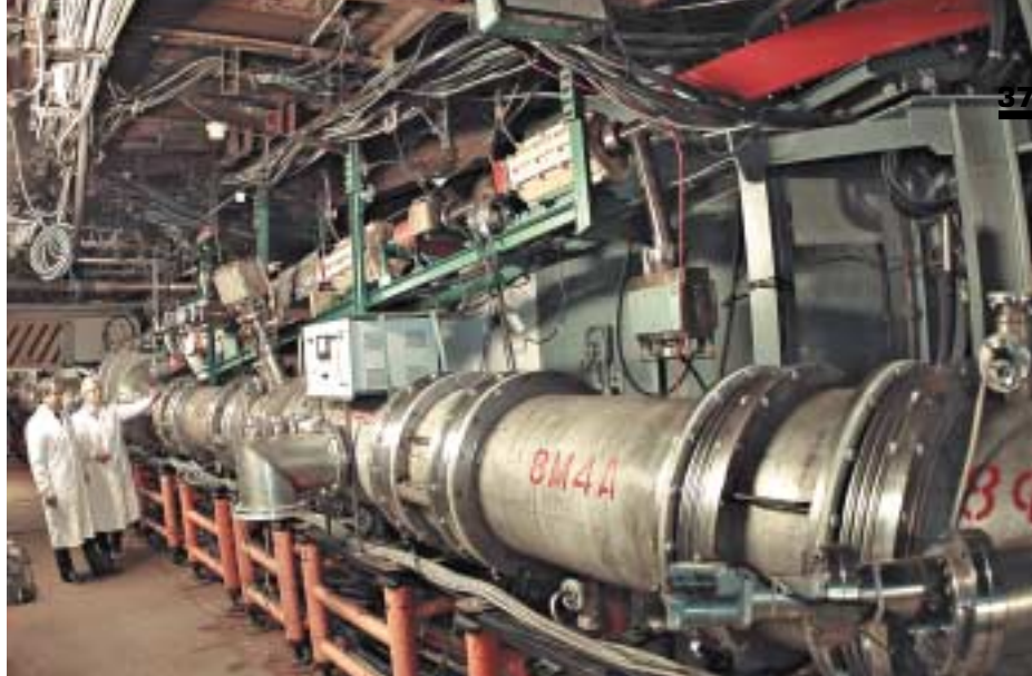
К 2009 году дубнинцы завершат модернизацию нуклотрона — уникального ускорителя тяжелых ионов, работающего только в ОИЯИ
