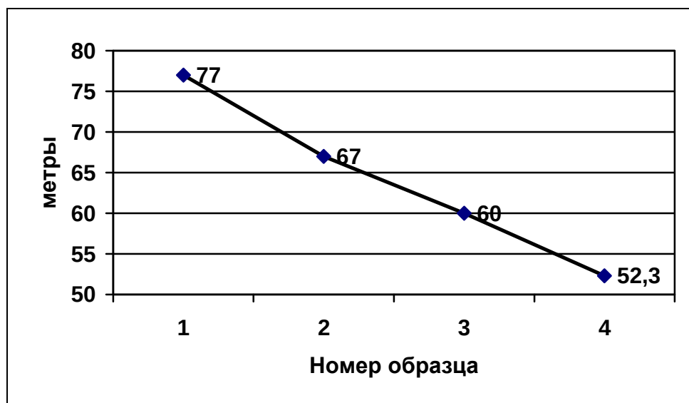
Рис. 4.7. Дальность полета стрел с исследуемыми наконечниками образует линейную зависимость
