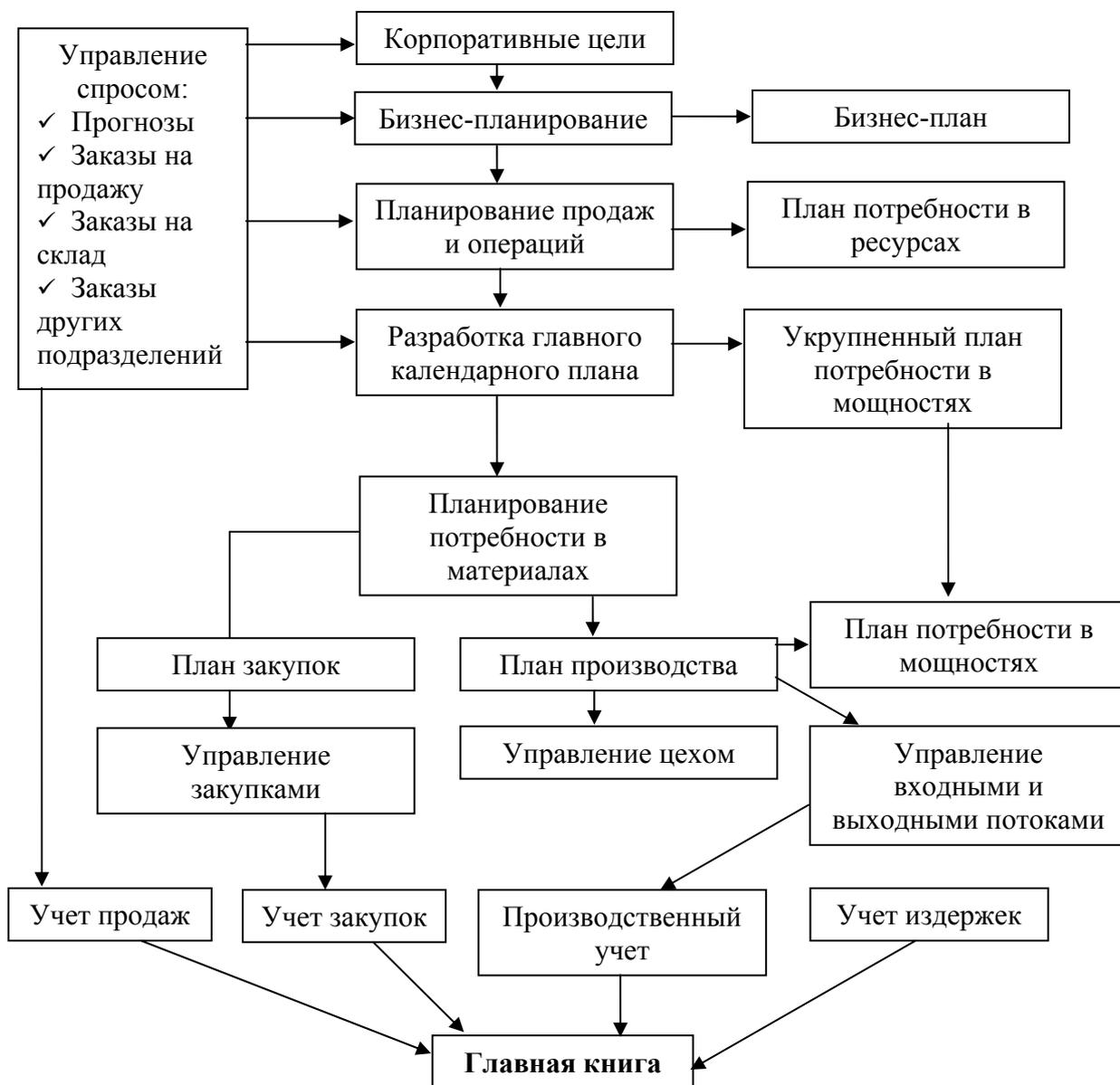
Рис. 2. Структура планового механизма в стандарте MRP II
