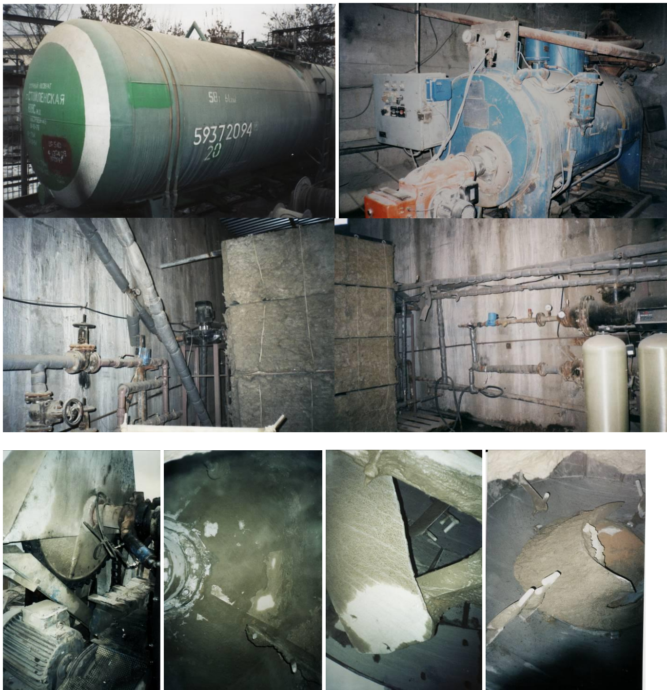
Рис. Гравитационная мешалка с лопастями принудительного перемешивания и корпусными подлопастями и зубьями объёмом 7 м.куб.
