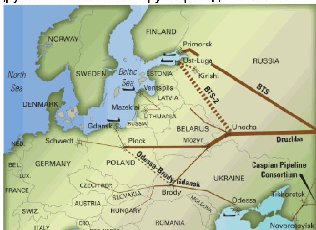
График 12. Схема магистрального нефтепровода «Дружба» и Балтийской трубопроводной системы
