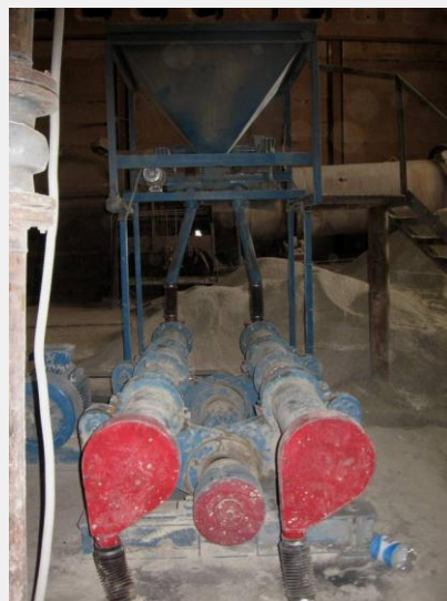
Рис. 1 Аппаратурная схема помольного модуля для получения механоактивированных премиксов для ССС.
