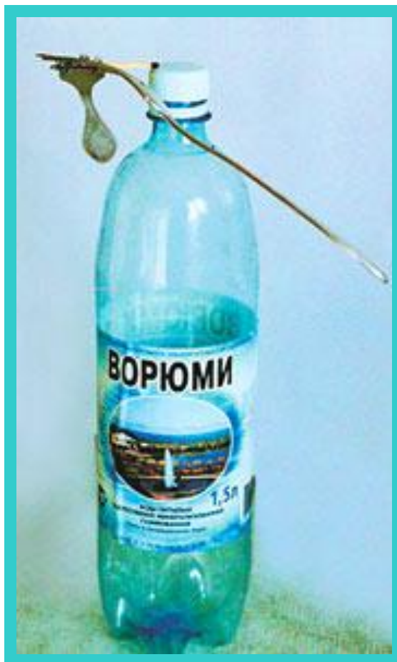
Рис. 1 Две вилки парят в воздухе. Центр тяжести и точка опоры системы совпадают.
