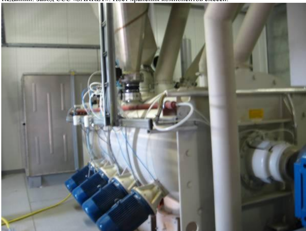
Кедайняй. Завод ССС «SAKRET». В цеху. Скоростной смеситель порошковых компонентов ССС.
