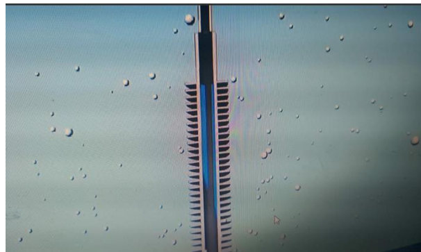
Термосифон – жидкий аммиак. Охлаждение земли без электричества
